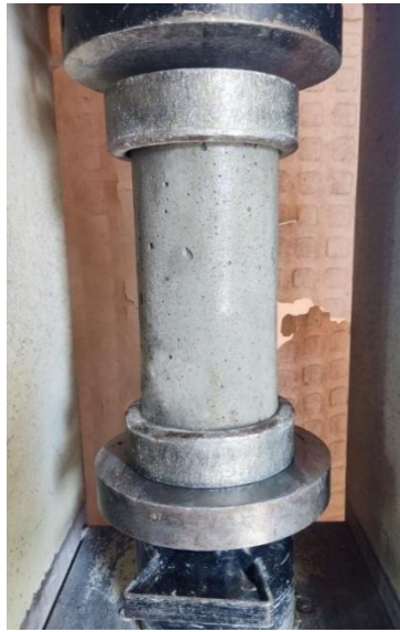
Ilustración 26 - Ubicación de espécimen en máquina de ensayo
