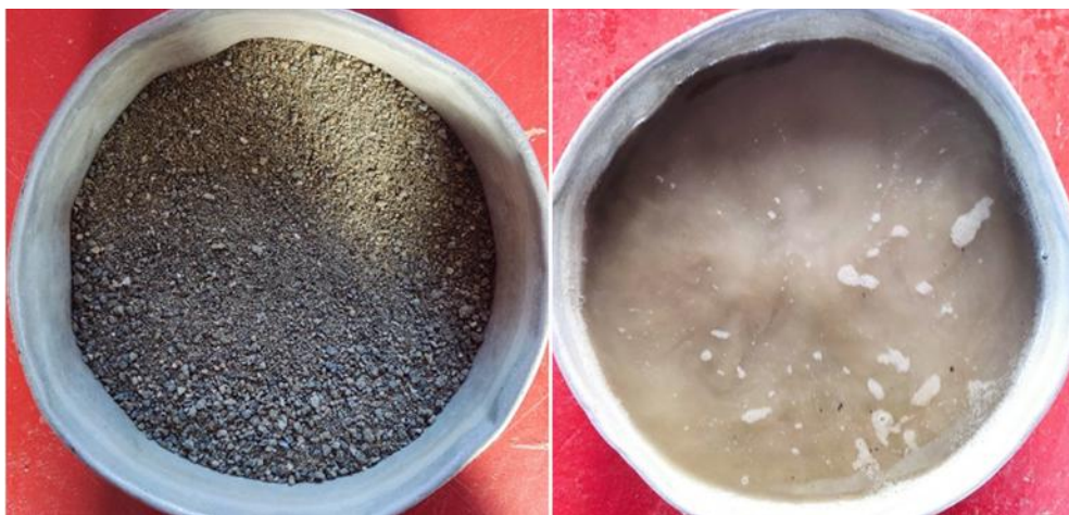
Ilustración 8 - Arena puesta en inmersión
