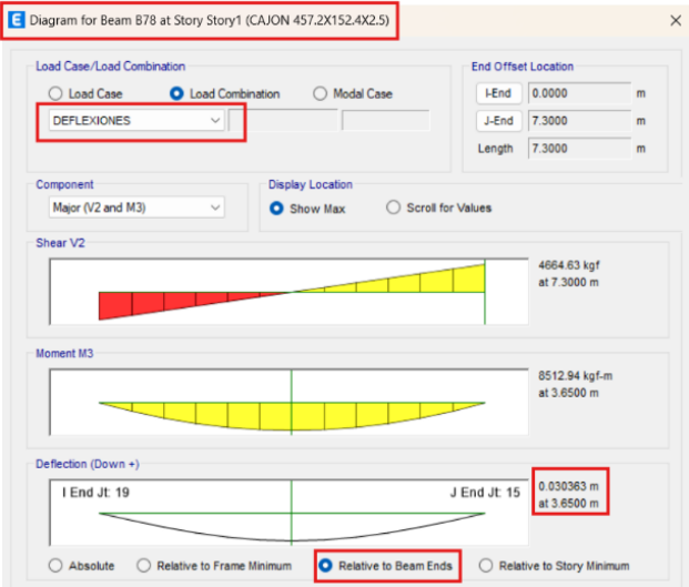
Figura 88. Deflexión máxima del perfil en cajón 457.2x152.4x2.5 en Etabs
