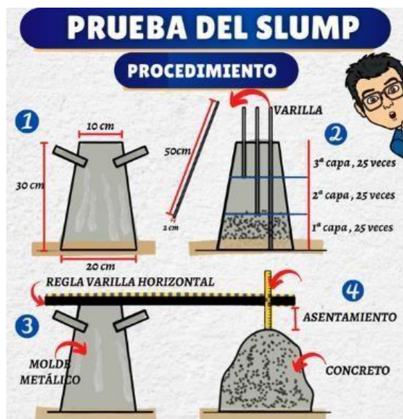
Ilustración 94 Esquema procedimiento del método ensayo asentamiento cono Abrams
