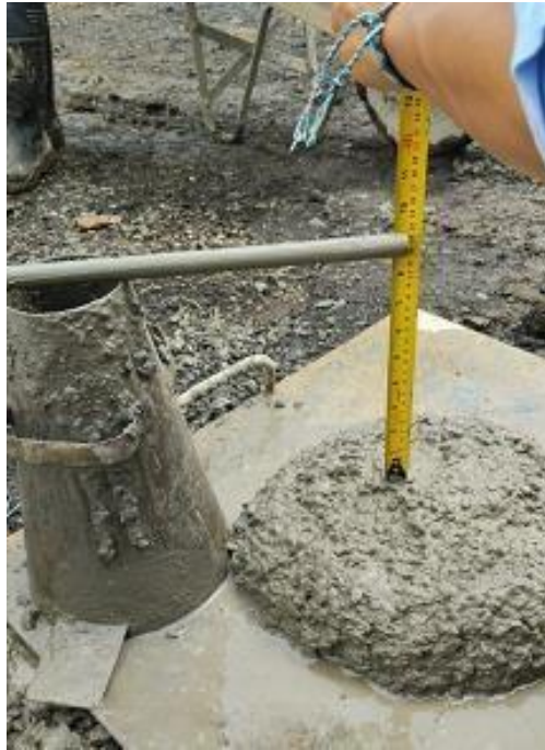
Ilustración 19 Ensayo del asentamiento del concreto cono Abrams
