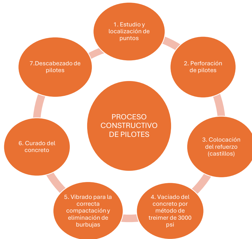
Ilustración 13 Proceso constructivo de pilotes
