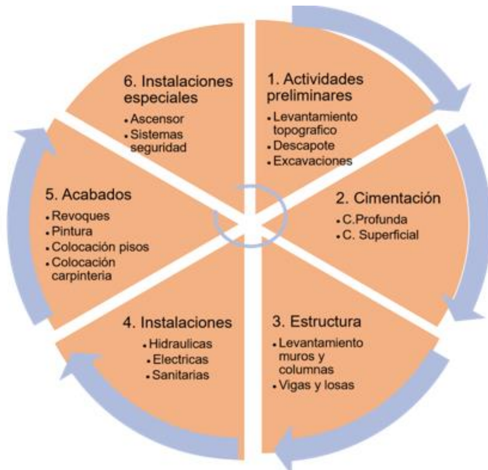
Ilustración 39 Ciclo de construcción del edificio ONIX
