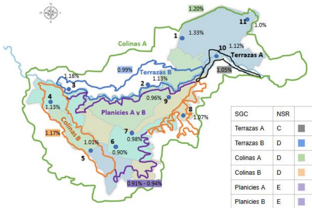
Figura 70. Valores de deriva para el edificio prototipo de pórticos de 3 pisos en los puntos de análisis de acuerdo con los estudios de SGC y UAN.
