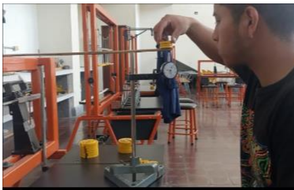
Ilustración 4, Viga bajo incrementos de carga.
