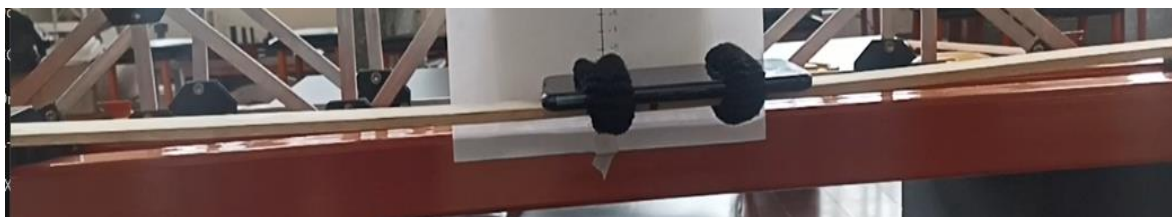
Ilustración 11. Viga simplemente apoyada madera de pino
