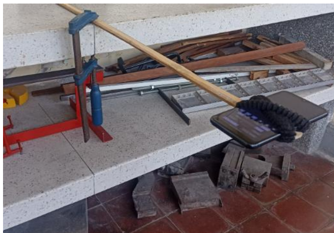
Ilustración 10. Viga en voladizo guadua
