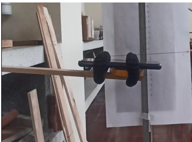
Ilustración 8. Viga en voladizo madera de pino (Probeta 1)
