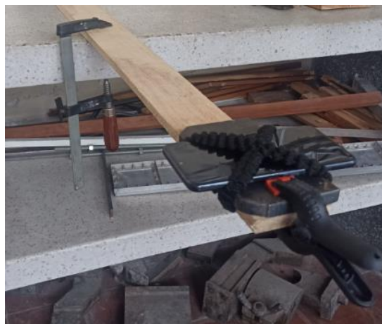
Ilustración 9. Viga en voladizo madera de pino (Probeta 2)
