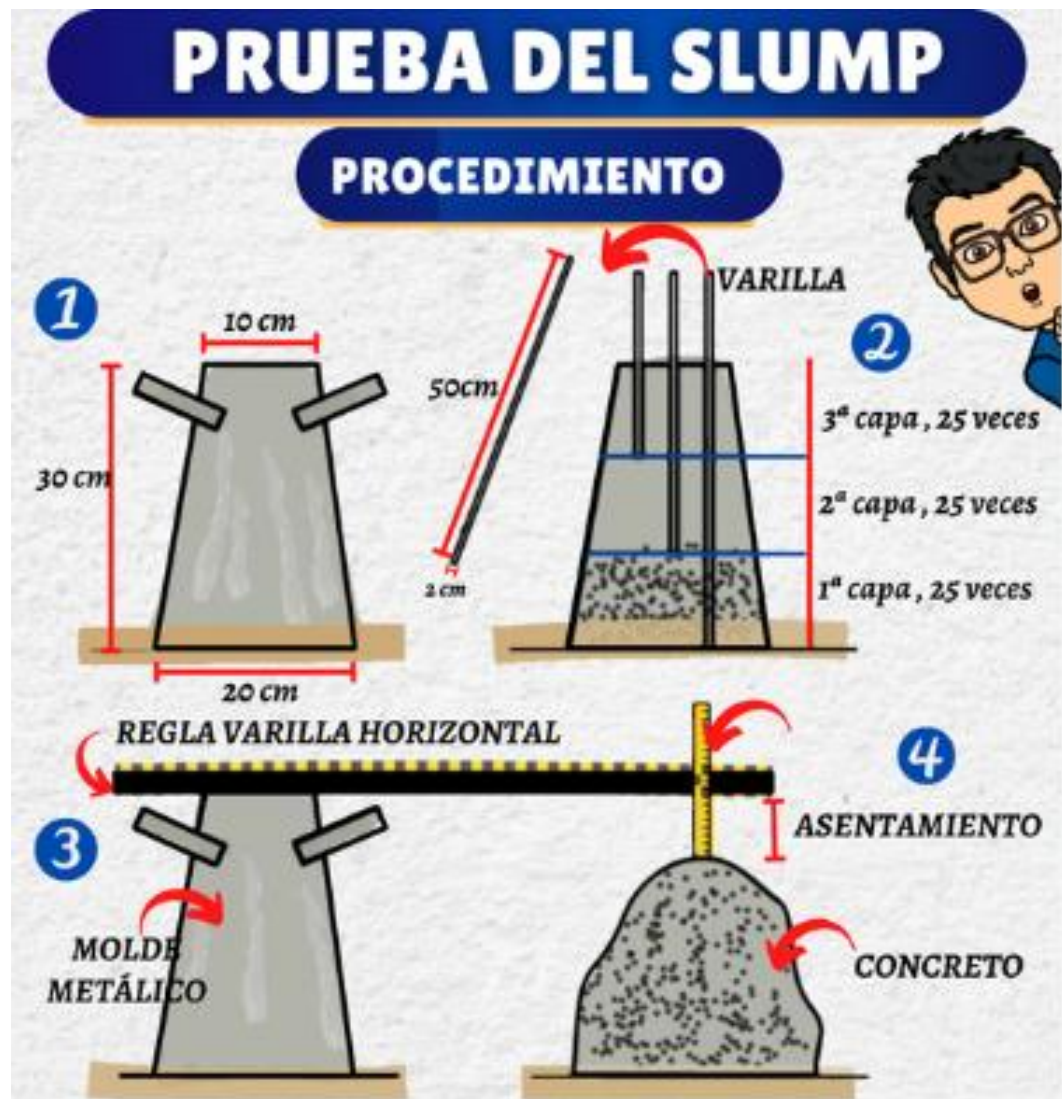
Ilustración 32. Esquema procedimiento del método ensayo asentamiento cono Abrams.
