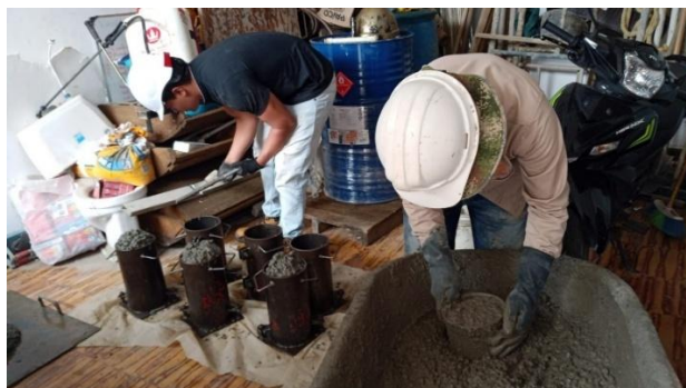
Ilustración 38. Llenado de los cilindros.
