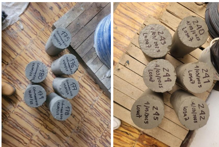
Ilustración 43. Marcación de los cilindros según la secuencia.
