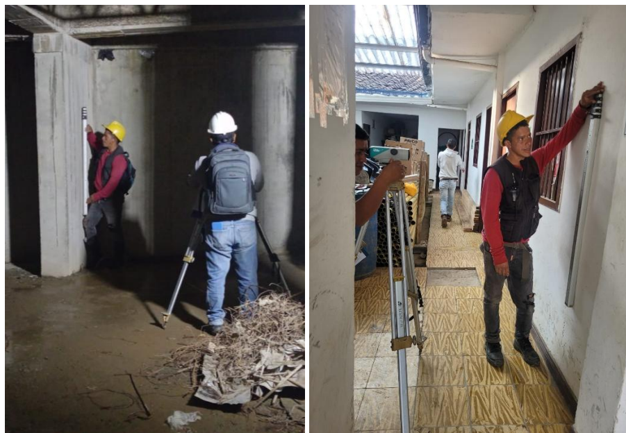
Ilustración 101. Toma de asentamientos con equipo de topografía.
