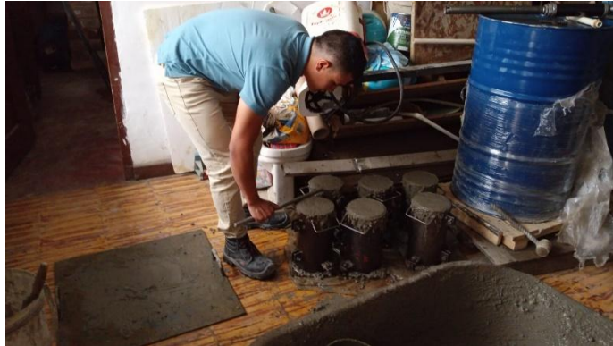
Ilustración 41. Enrase de los cilindros.
