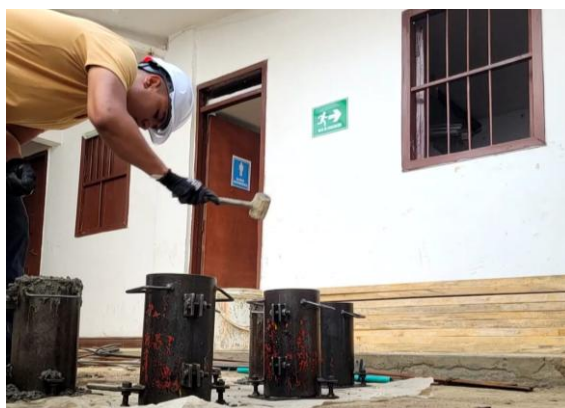
Ilustración 40. Golpes con el chipote alrededor del cilindro.
