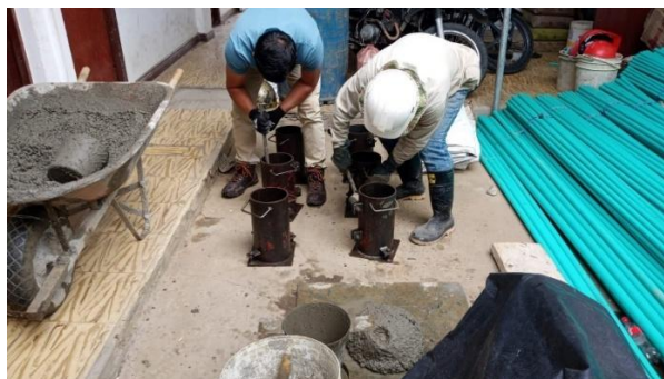
Ilustración 39. Compactado de los cilindros.
