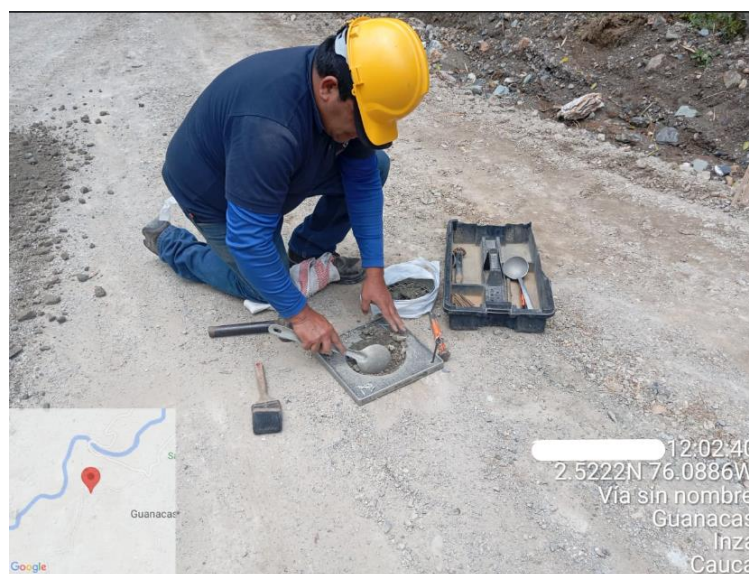
Ilustración 48 Ensayo de Cono de Arena INV-E-161-07
