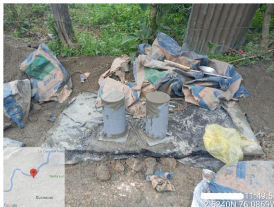
Ilustración 73. Muestras de Concreto Según INV E-410
