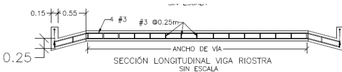
Figura 51 Sección longitudinal de riostra
