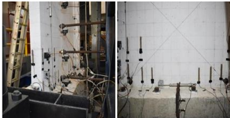
FIGURA 1. Instrumentación de un muro de concreto reforzado con más de 30 sensores (potenciómetros, LVDT's, galgas) [25].
