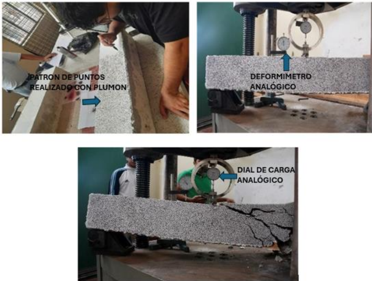
FIGURA 4. Pruebas preliminares de medición de desplazamientos con DIC, en el laboratorio de estructuras. a) patrón de puntos, b) prueba de carga, c) falla de la viga.
