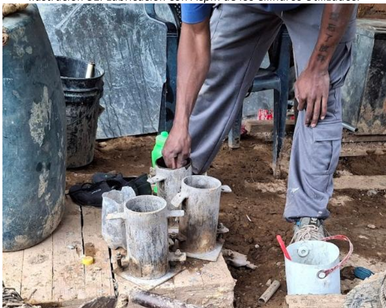
Ilustración 51. Lubricación con Acpm de los Cilindros Utilizados.
