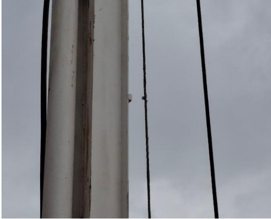
Ilustración 117. Piloteadora con Cableado en Mal Estado.
