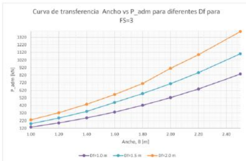
Imagen 9 Curva de Transferencia de Carga para diferentes profundidades y anchos de zapata en función de Carga Admisible
