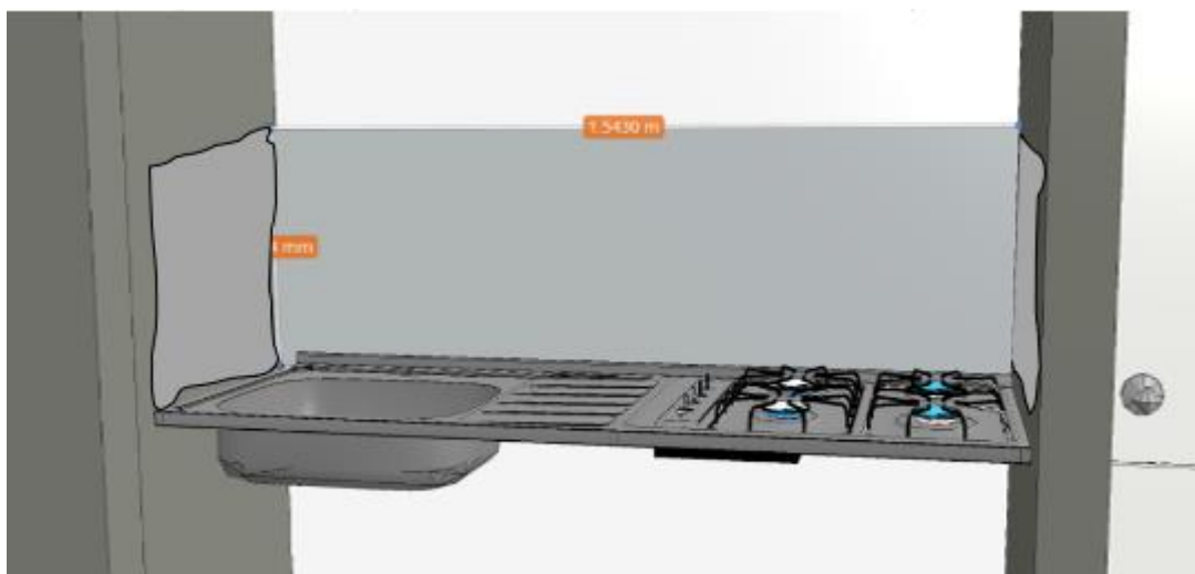
63 - Enchape en zona de cocina (Cerámica egeo blanca 30x60)
