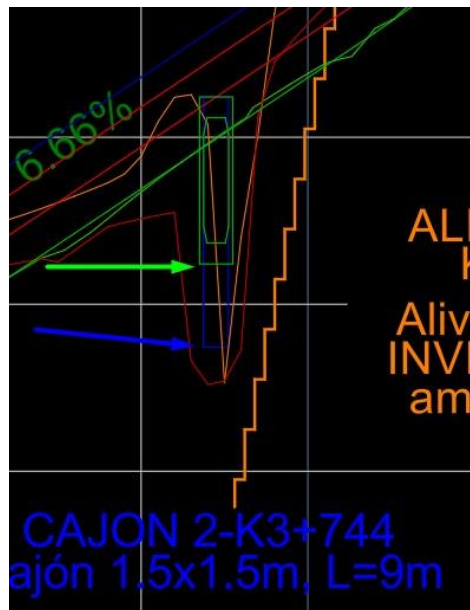
Ilustración 19: Alcantarilla cajón 1.5x1.5m por encima de la línea de perfil
