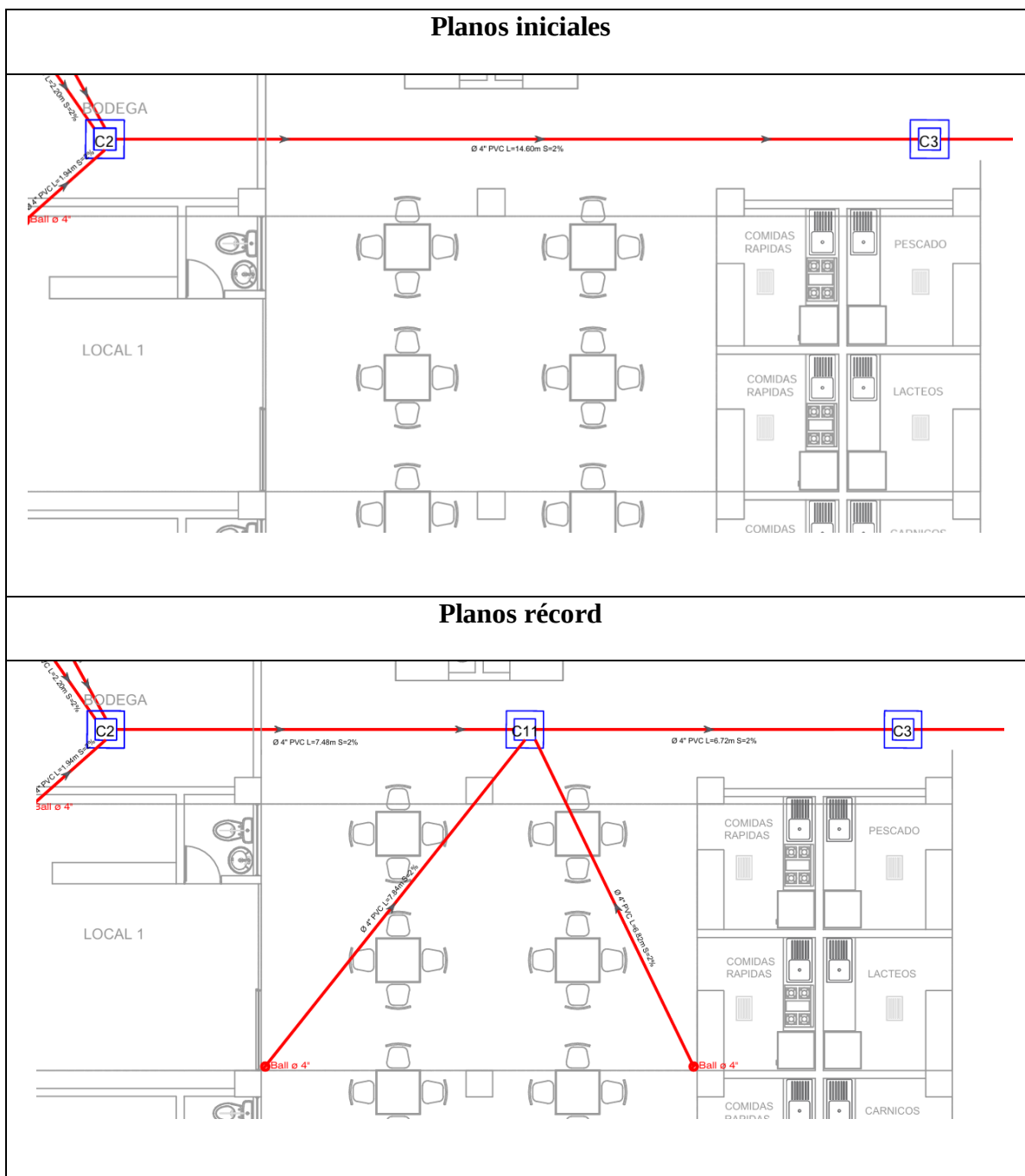
Figura 66 Adición de bajantes y caja de inspección #1
