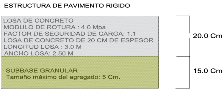
Ilustración 6 Estructura de pavimento rígido
