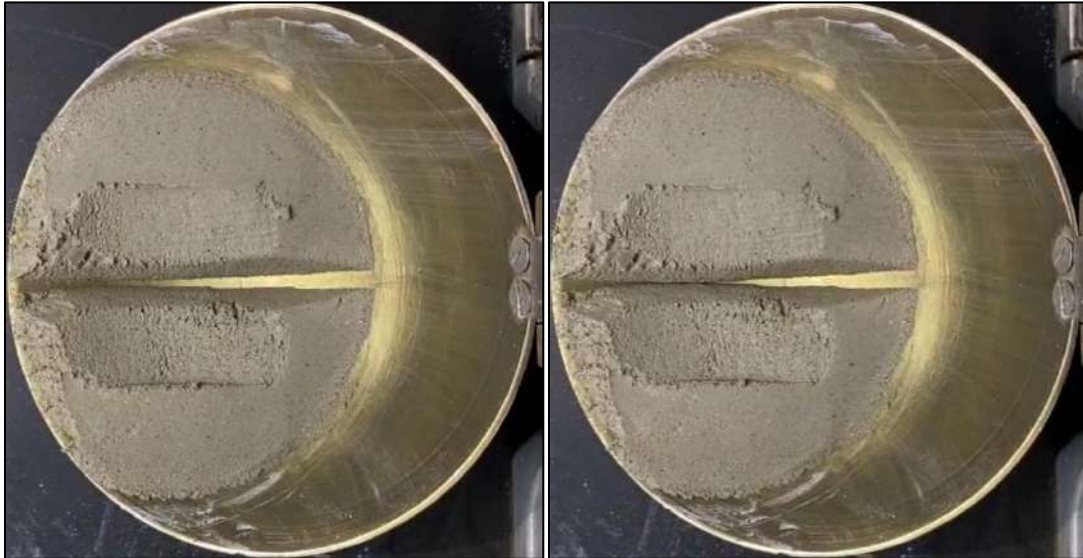
Ilustración 109. Cierre de ranura a 24 golpes
