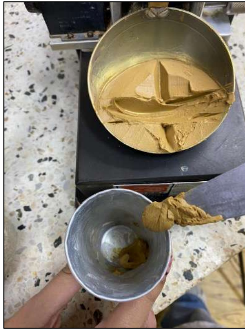
Ilustración 54 Se toma el testigo de humedad
