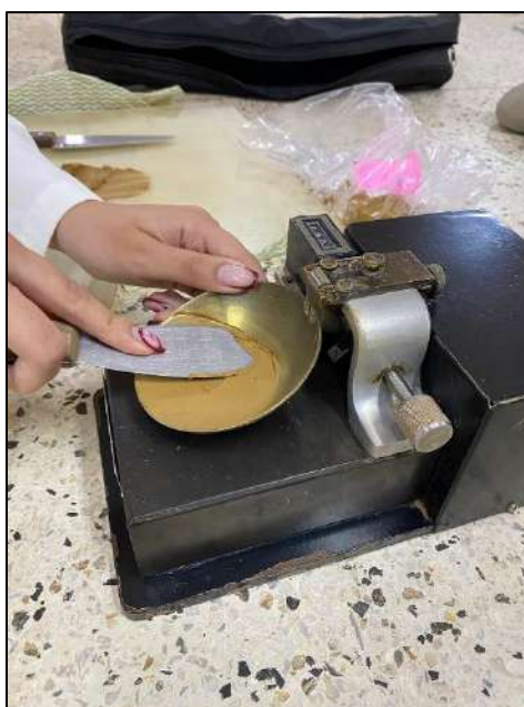
Ilustración 49 Montaje del suelo en la cazuela
