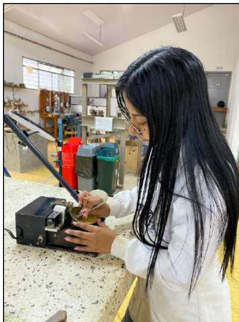
Ilustración 51 Se ranura el suelo
