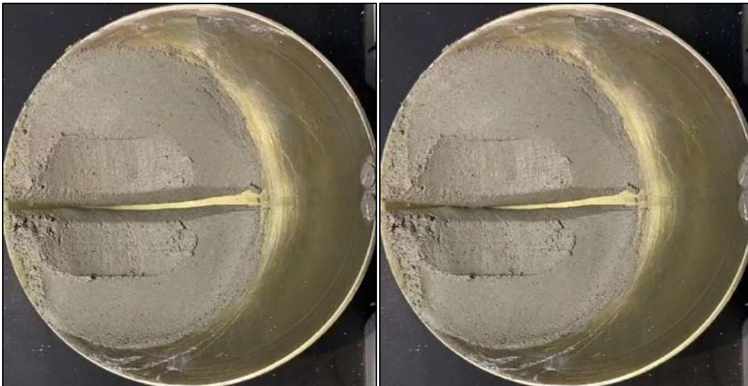
Ilustración 108. cierre ranura a 16 golpes
