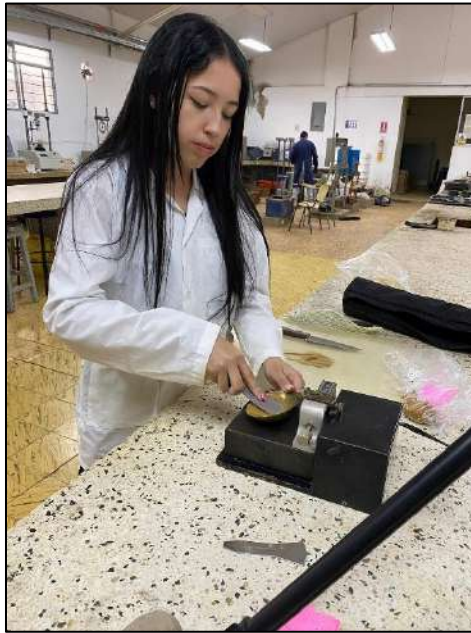
Ilustración 51 Se ranura el suelo
