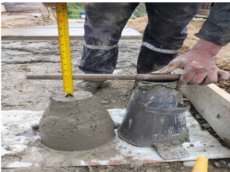
Ilustración 16 Ensayo de asentamiento
