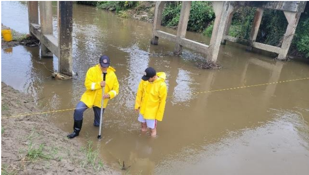
Foto 5-4: Aforo de caudal líquido usando molinete digital de velocidad integrada
