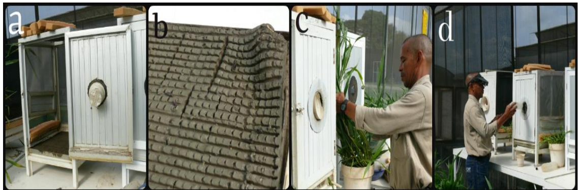
Figura 18. Cámara de oviposición; a. Cámara con abertura frontal, lateral y sustrato; b. Piso de barro con cortes reticulares; c. Introducción del forraje como fuente de alimentación; d. Incorporación de insectos adultos a la cámara
