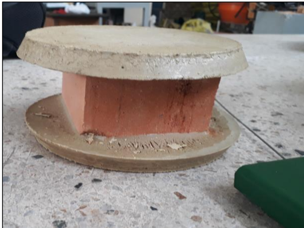
Ilustración 18. Alistamiento para ensayo a compresión.
