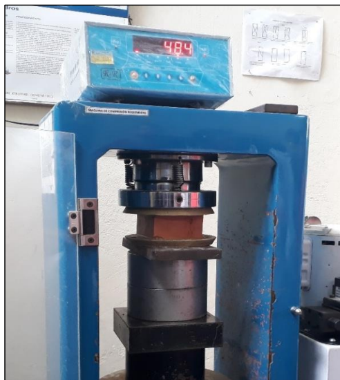
Ilustración 19. Ensayo de compresión.
