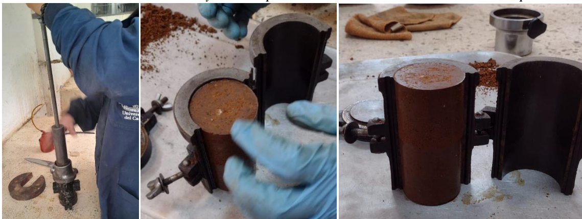
Ilustración 24. Ensayo de compactación Proctor Estándar con Molde Japonés.
