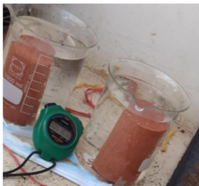
Ilustración 26. Ensayo de estabilidad al agua realizado por inmersión.
