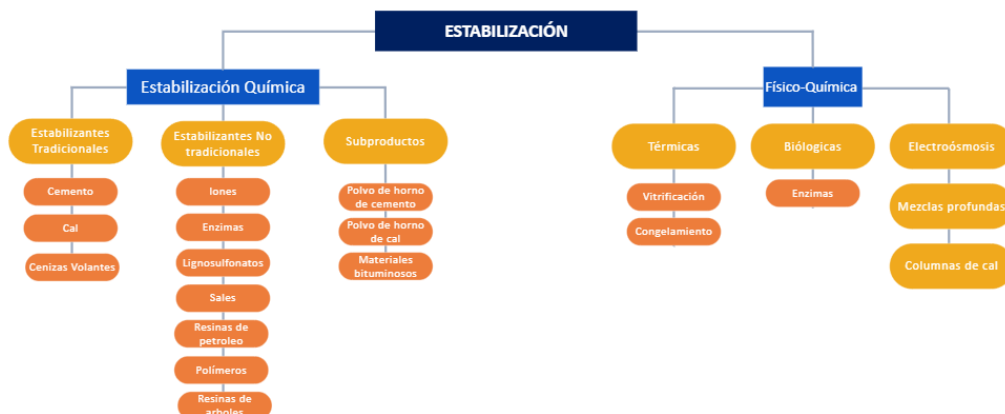
Ilustración 8. Estabilización de suelos
