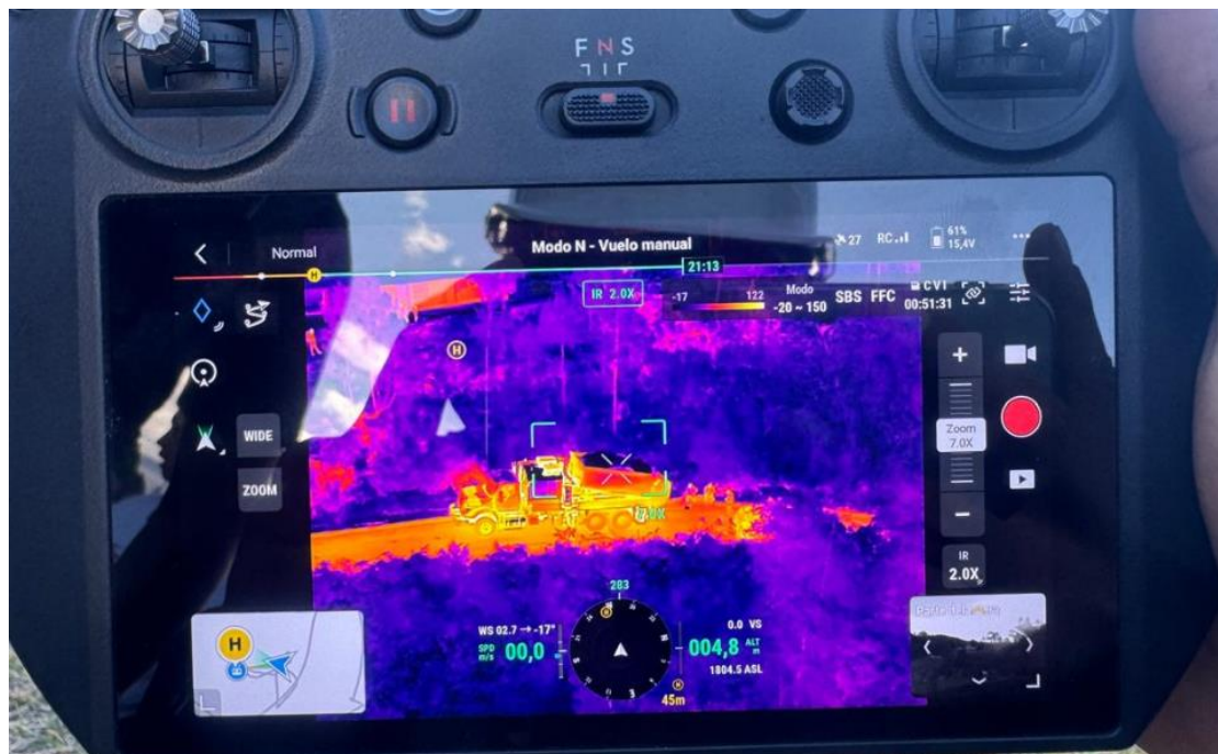
Figura 100. Seguimiento térmico del tratamiento superficial doble mediante dron.
